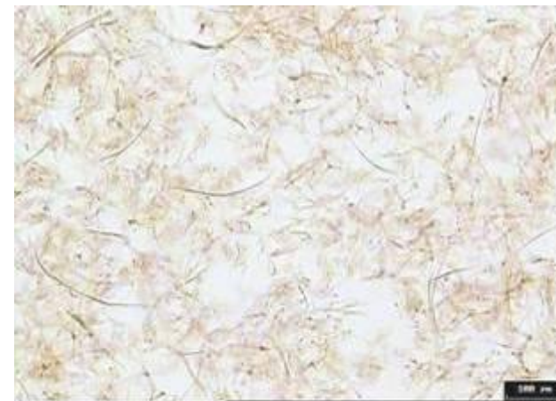
Pulp H - pre-hydrolysis kraft cooking (kappa 20)
